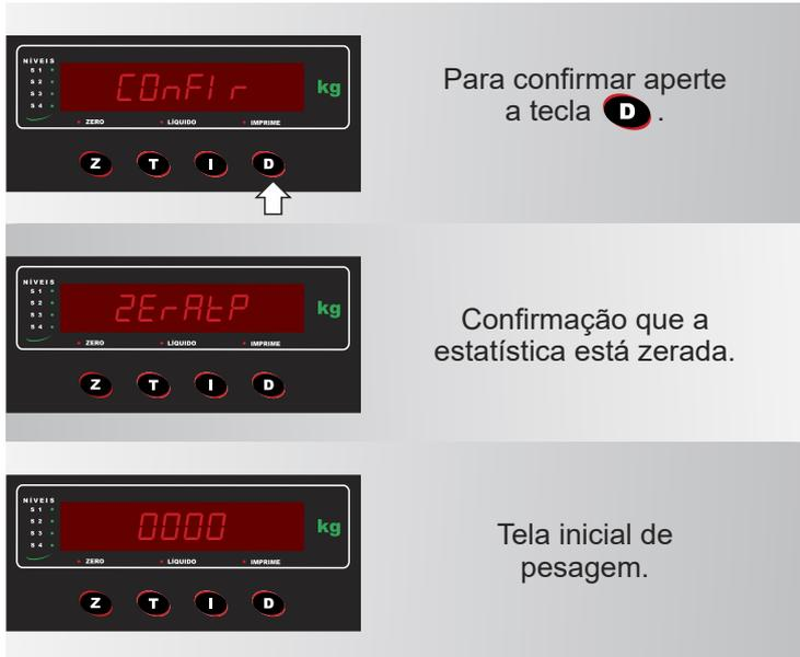
Após ter feito a captura ("led" piscando) está informação ficará salva automaticamente na memória da balança. (Se achar necessário anote o peso do animal). Após ter feito todos os procedimentos no animal (medicamentos, examinar, pesar), retire o animal da balança, com isso o peso destrava e aparece a mensagem de "ZERA", a balança irá zerar automaticamente com qualquer resíduo que ficar sobre ela até 4% do peso.
